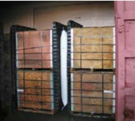
La superficie anti-derrapante agarra la bolsa de aire, asegurando que permanezca en su sitio
